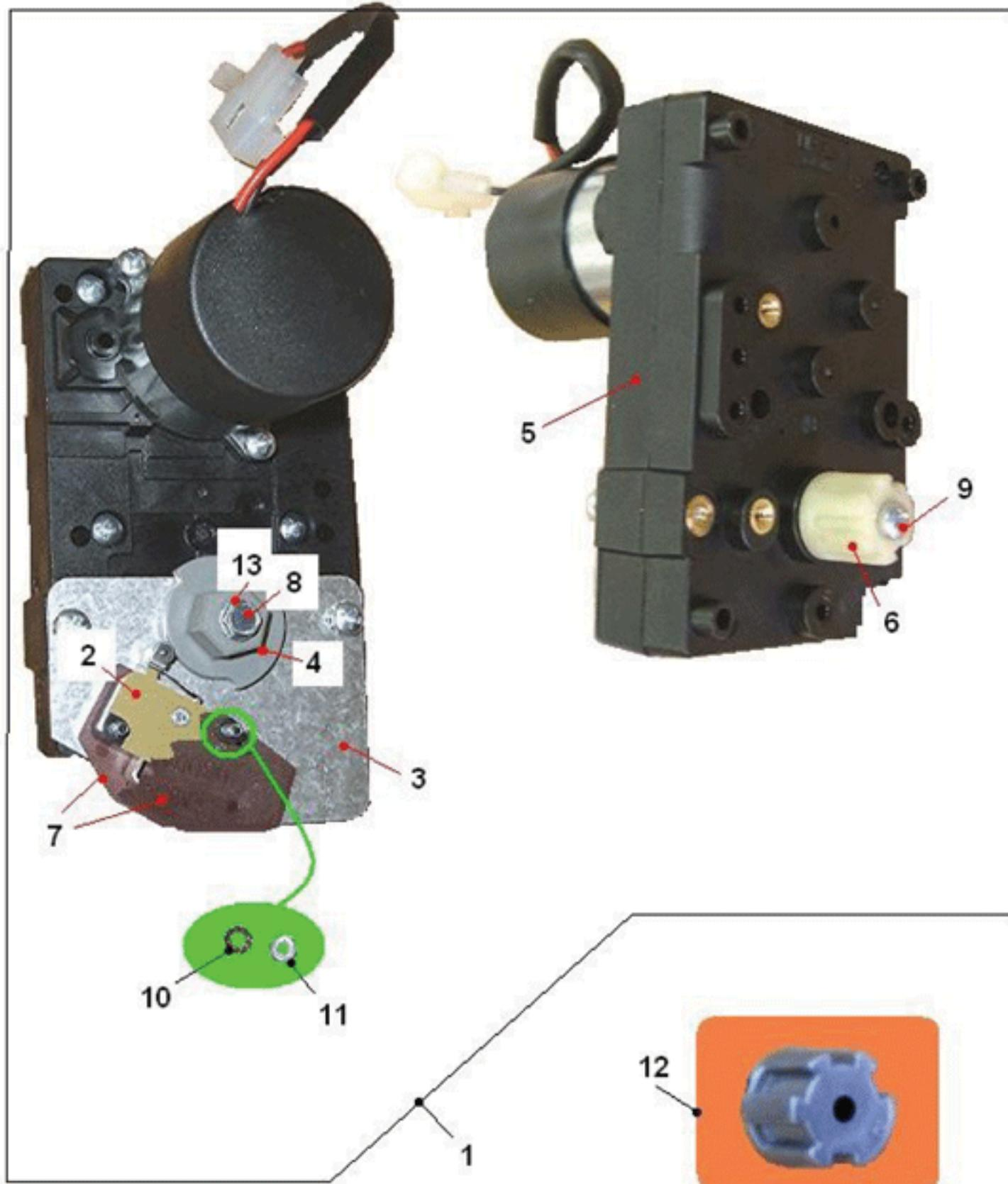
Tavola: **POMPA 220V - CONTATORE VOLUMETRICO(24)**
